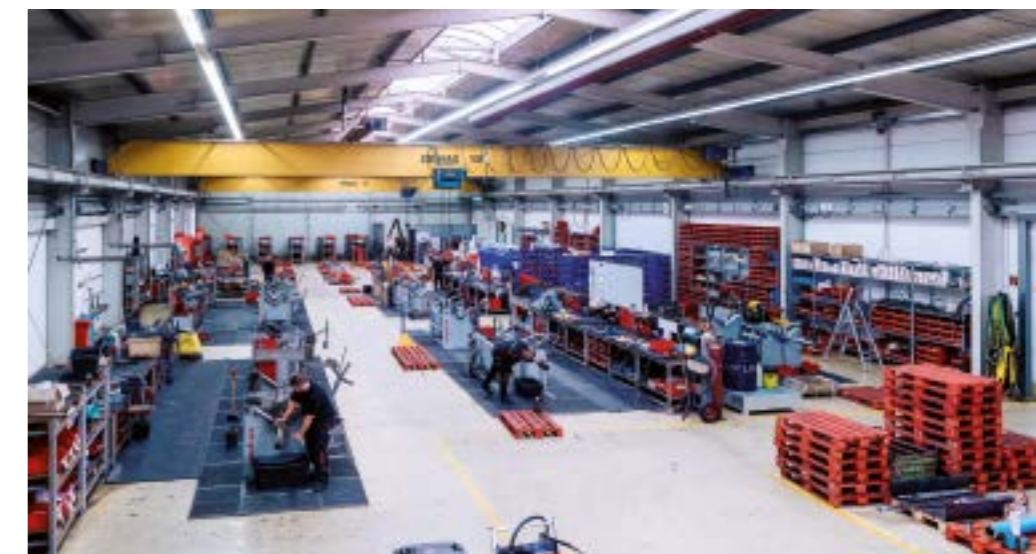
» Hier kümmern sich 34 Mitarbeiter um die herstellerunabhängige Reparatur von Hydraulikzylindern sämtlicher Baugrößen. » Here a team of 34 technicians repair the hydraulic cylinders of all manufacturers and dimensions.
