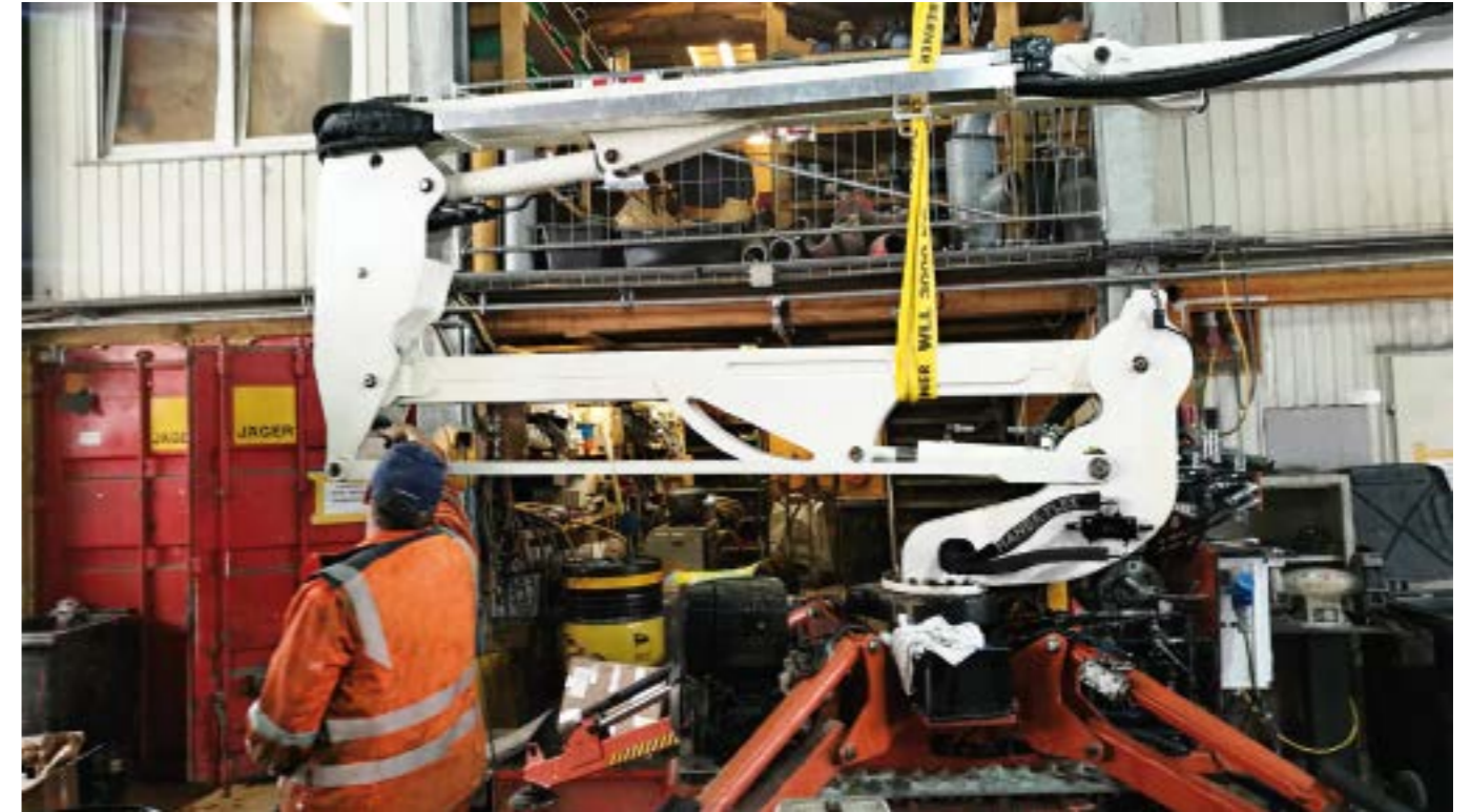
» Die Revision des Hubsteigers war dann Routine: In weniger als zwei Tagen tauschte Kraxner rund 200 m Schlauchleitungen aus, die an Bord des Servicefahrzeugs abgelängt und verpresst wurden. » Servicing the cherry picker was then routine. In under two days Kraxner replaced approx. 200 m of hose lines, which were all cut to length and crimped in the service vehicle.
