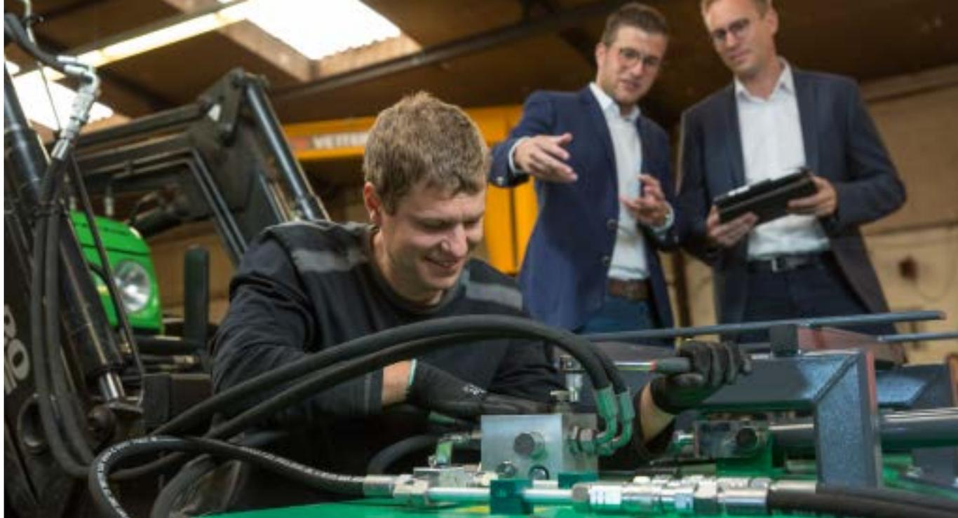
Für SMB wurde ein zentraler Ventilblock von HANSA-FLEX entwickelt. Dadurch kann der restliche Hydraulikkreislauf platzsparender ausgelegt werden.
