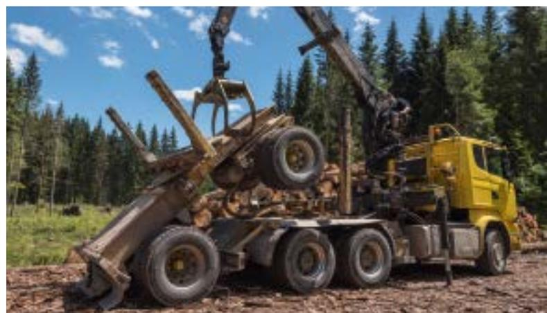
Knarzend setzt sich eine Seilwinde in Bewegung und lässt den kleinen Anhänger – den sogenannten Nachläufer – ab, bis er hinter dem Fahrzeug steht. Nur das Drahtseil und zwei Kabel verbinden ihn jetzt noch mit der Zugmaschine.
