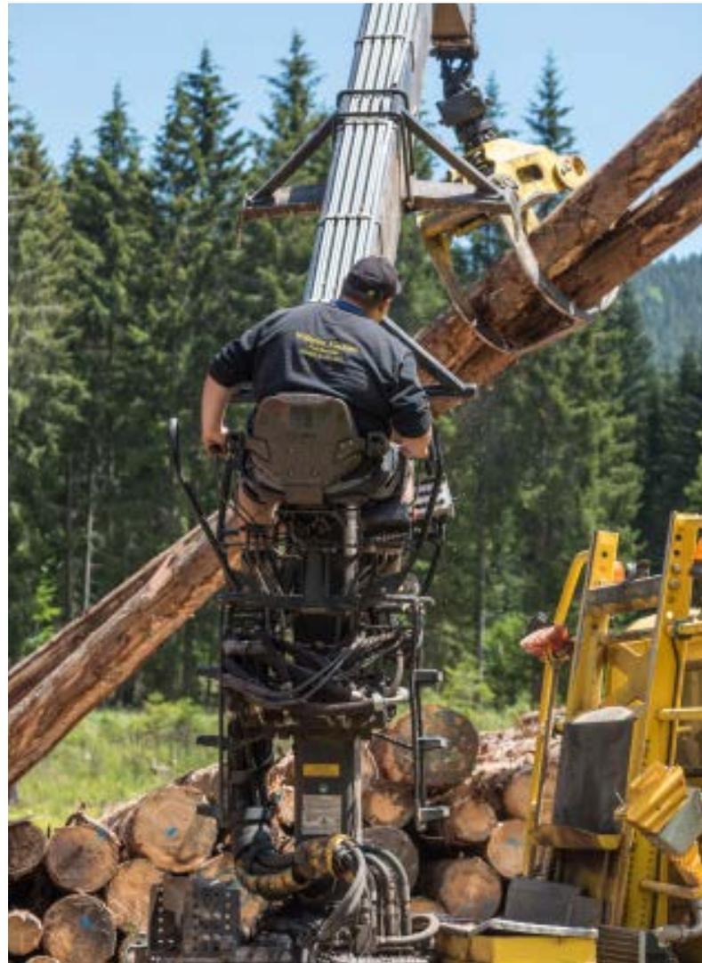
Mächtige Hydraulikzylinder setzen den 8,60 m langen Arm in Bewegung. An dessen Spitze ist ein ebenfalls hydraulisch bewegter Greifer.
