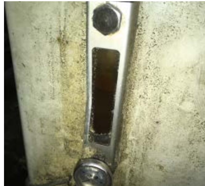
» Bild 2: Hinweise auf eine zu hohe Öltemperatur: dunkle Farbe und atypischer Geruch. » Image 2: Signs of increased fluid temperature: it begins to discolour or take on an unusual smell.
