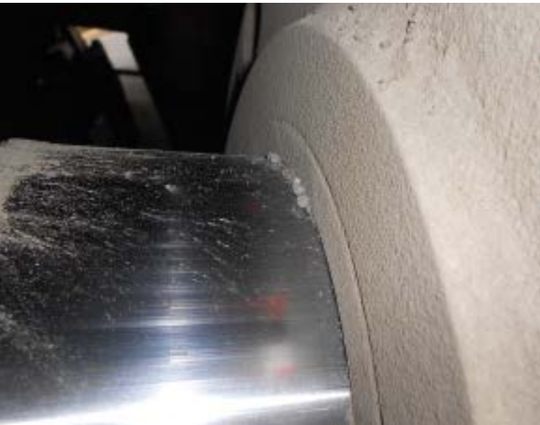
» Bild 1: Verschmutzter Hydraulikzylinder mit Verschleißriefen. » Image 1: Hydraulic cylinder with dirt and scratching caused by wear.
