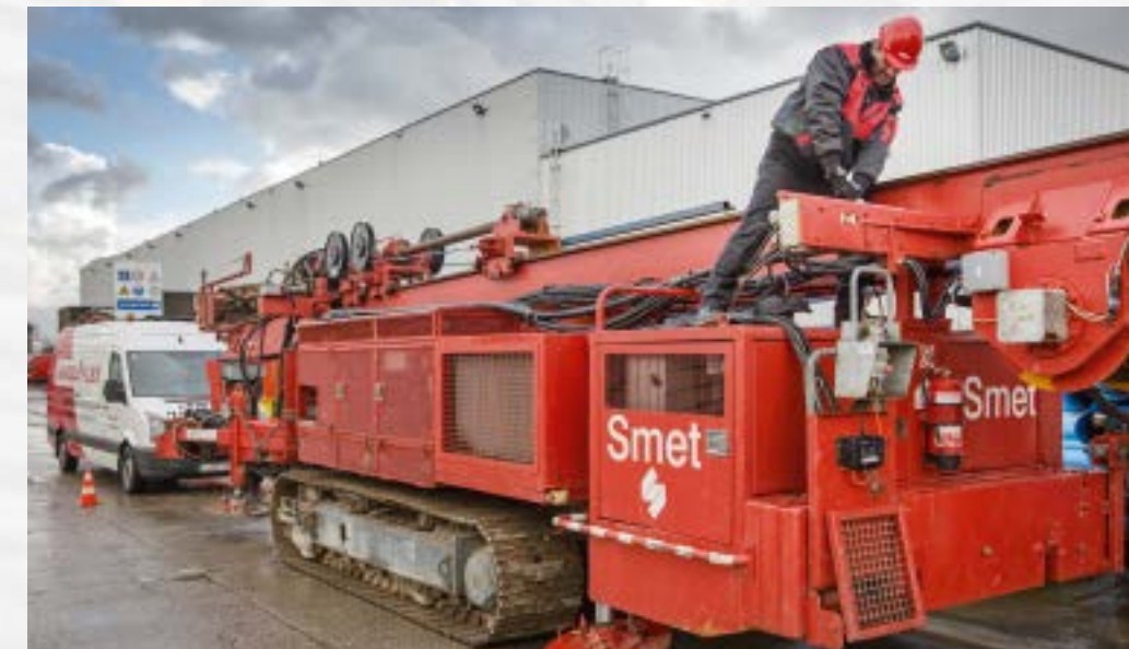
» Die Smet Group setzt vorwiegend HD 700 PRO-Schlauchleitungen mit 4 oder 6 Spiralen aus höchstzugfestem Stahldraht ein. » The Smet Group mainly uses HD 700 PR hose lines with 4 or 6 steel-wire spirals.
