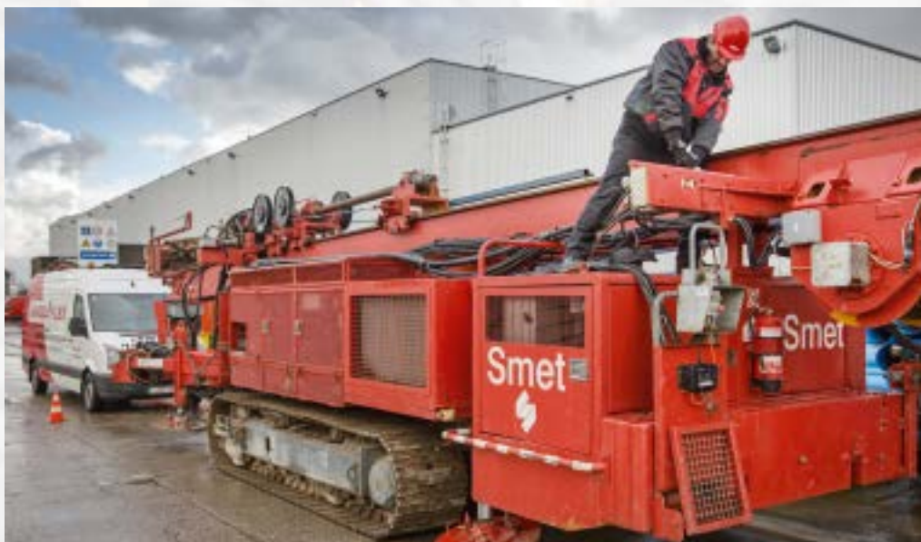
» Die Smet Group setzt vorwiegend HD 700 PRO-Schlauchleitungen mit 4 oder 6 Spiralen aus höchstzugfestem Stahldraht ein.
